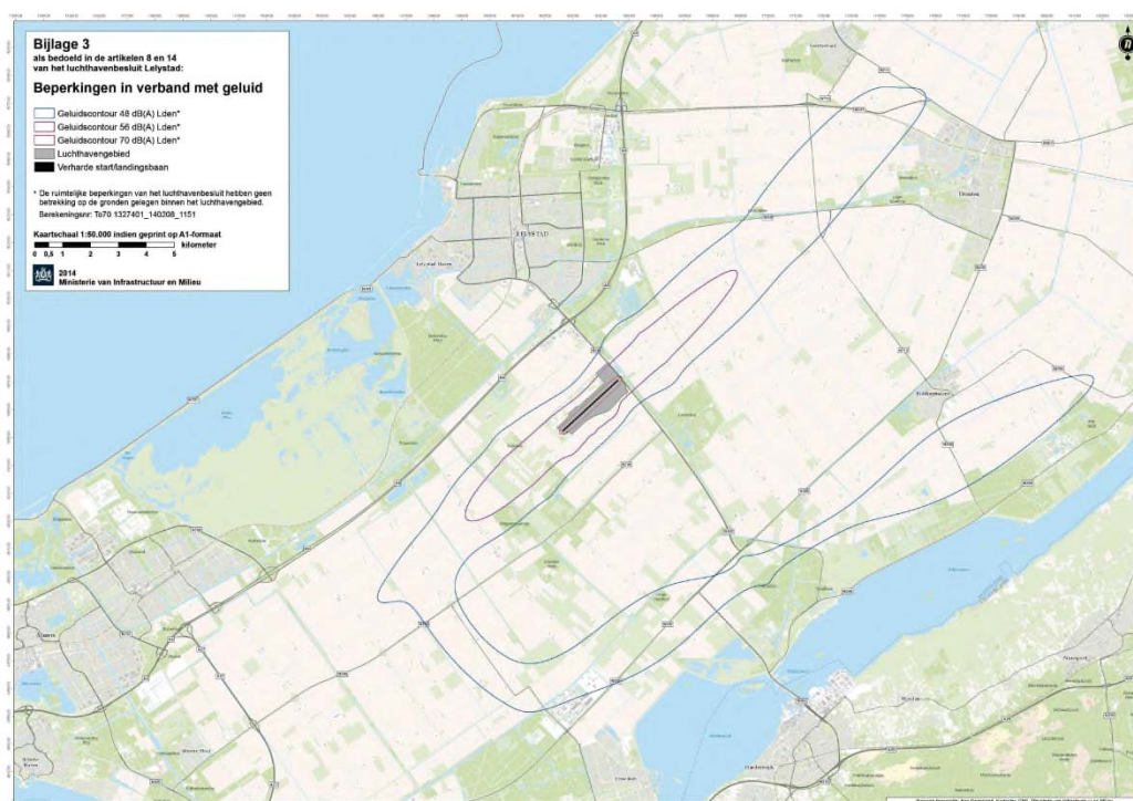
Figuur 5.1: Geluidscontour Lelystad airport luchthavenbesluit.
